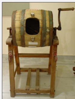
Χειροκίνητη περιστροφική βουτυροκάδη (Α/Μ 0170), κατασκευής R. A. Lister & Co. Ltd. (φωτ. Μ. Μαυροειδή, 2008)
