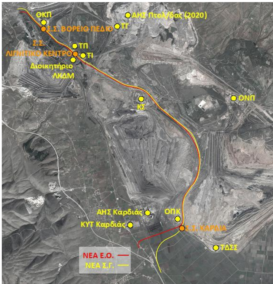
Εικόνα 1: Χάραξη νέας σιδηροδρομικής γραμμής Κοζάνης – Πτολεμαΐδας μέσα από τη βιομηχανική περιοχή ΔΕΗ και προτεινόμενη χωροθέτηση τριών (3) σιδηροδρομικών στάσεων.
